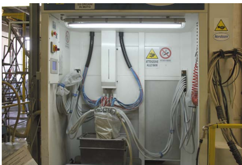
14 e 14a - "Soffietto" di eliminazione polveri al contatto dei ganci per mantenere pulita l'area. Blower for removing powder in contact with the hooks in order to keep the area clean.
