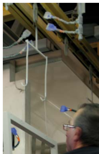
14 e 14a - "Soffietto" di eliminazione polveri al contatto dei ganci per mantenere pulita l'area. Blower for removing powder in contact with the hooks in order to keep the area clean.
