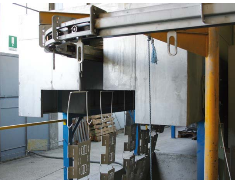
16a e 16b – I pezzi in ingresso nel forno di cottura del tipo "a campana". The pieces entering the "bell-SHAPED" baking oven.
